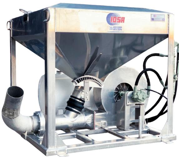
La alimentadora de bordo IOSA, es un equipo que se usa para alimentar camarones o peces, lanzando el alimento que baja de la tolva hacia el venturi de la alimentadora, alimento que es impulsado por un blower, lanzándolo a más de 25 metros, del bordo hacia el estanque a alimentar.
