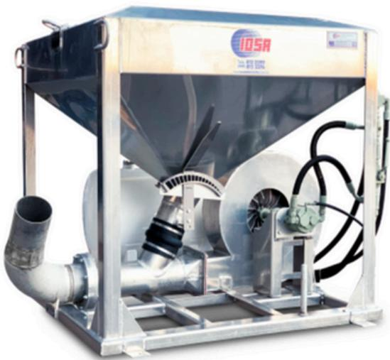
Es un equipo que se usa para alimentar camarones o peces, lanzando el alimento que baja de la tolva hacia el venturi de la alimentadora, alimento que es impulsado por un blower, lanzandolo a más de 25 metros, del bordo hacia el estanque a alimentar.
