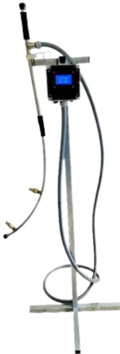
Bastón de control y monitoreo de temperatura, este equipo le permite trabajar sobre los rangos óptimos de temperatura durante las cosechas para el shock térmico, así como también el control de la temperatura en la freezadora, todo esto para lograr tener controlen los procesos de frizado y shock térmico del camarón.
